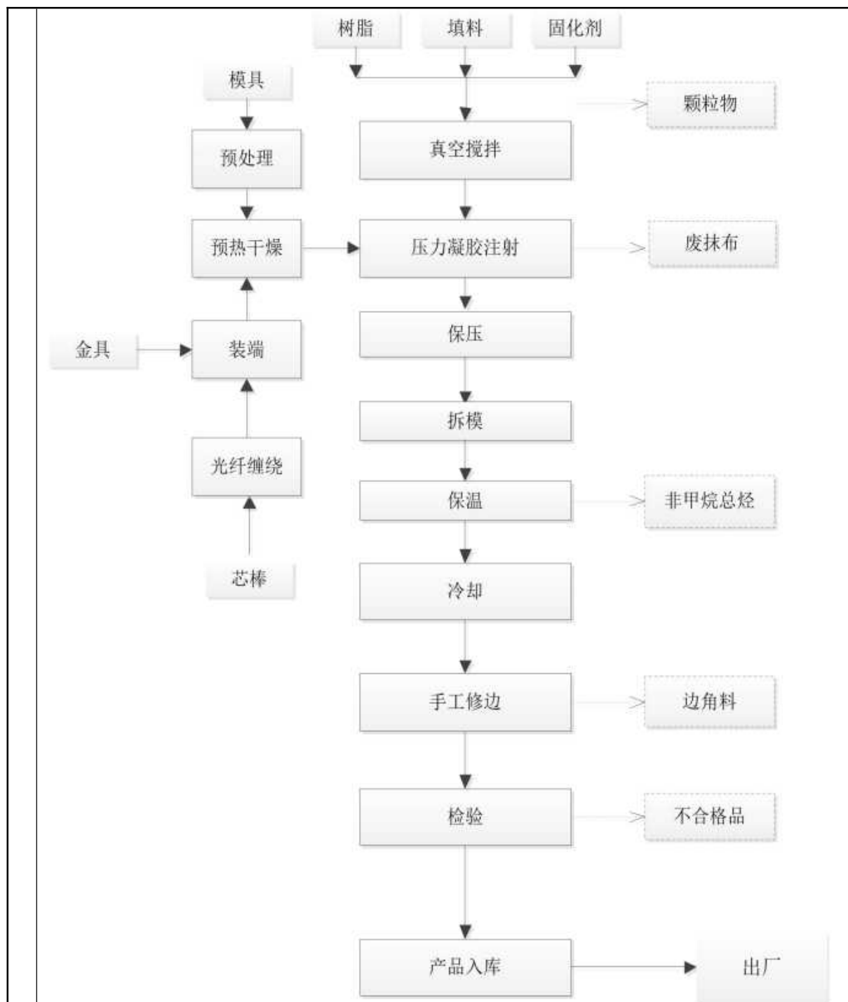
图 2-3 本项目工艺流程及产污环节示意图
