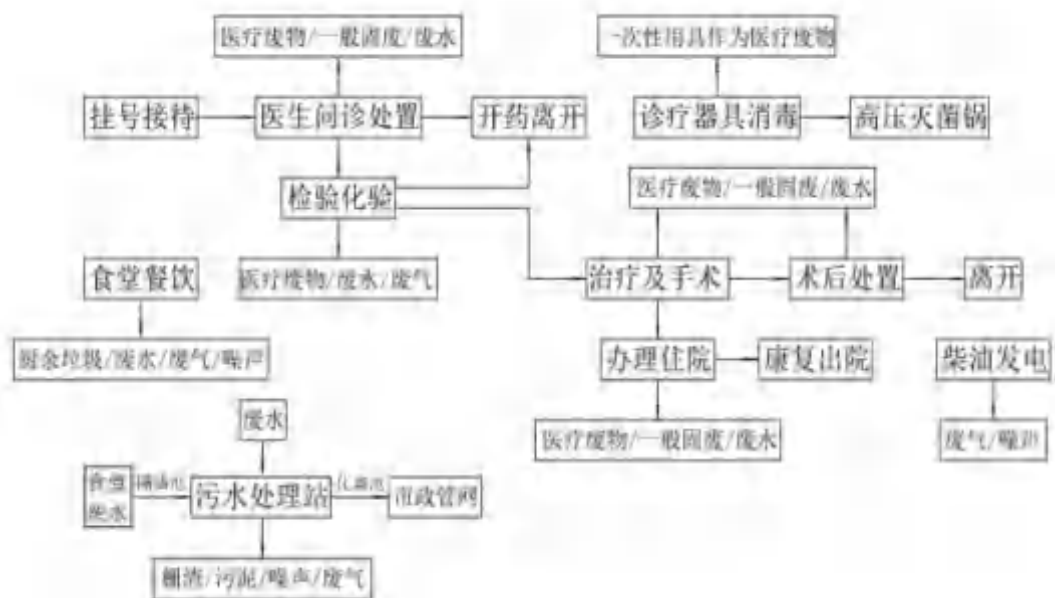
图 2-4 项目运营期工艺流程和产污环节示意图
