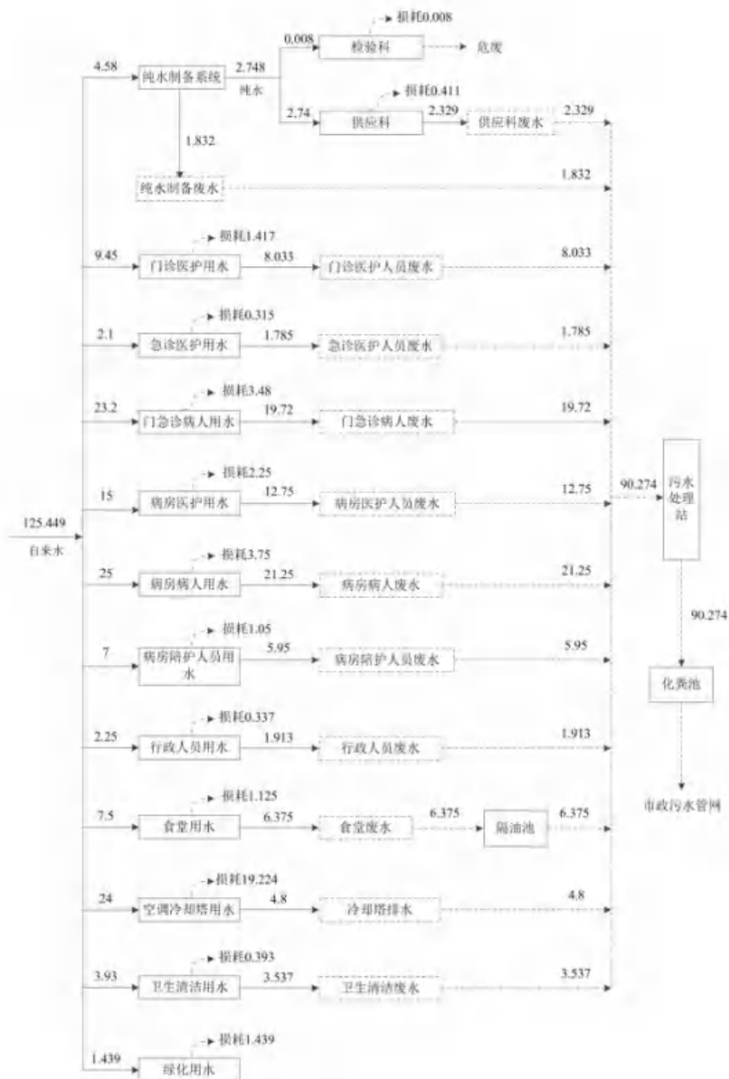
图 2-1 项目日水平衡图（单位：m³/d）
