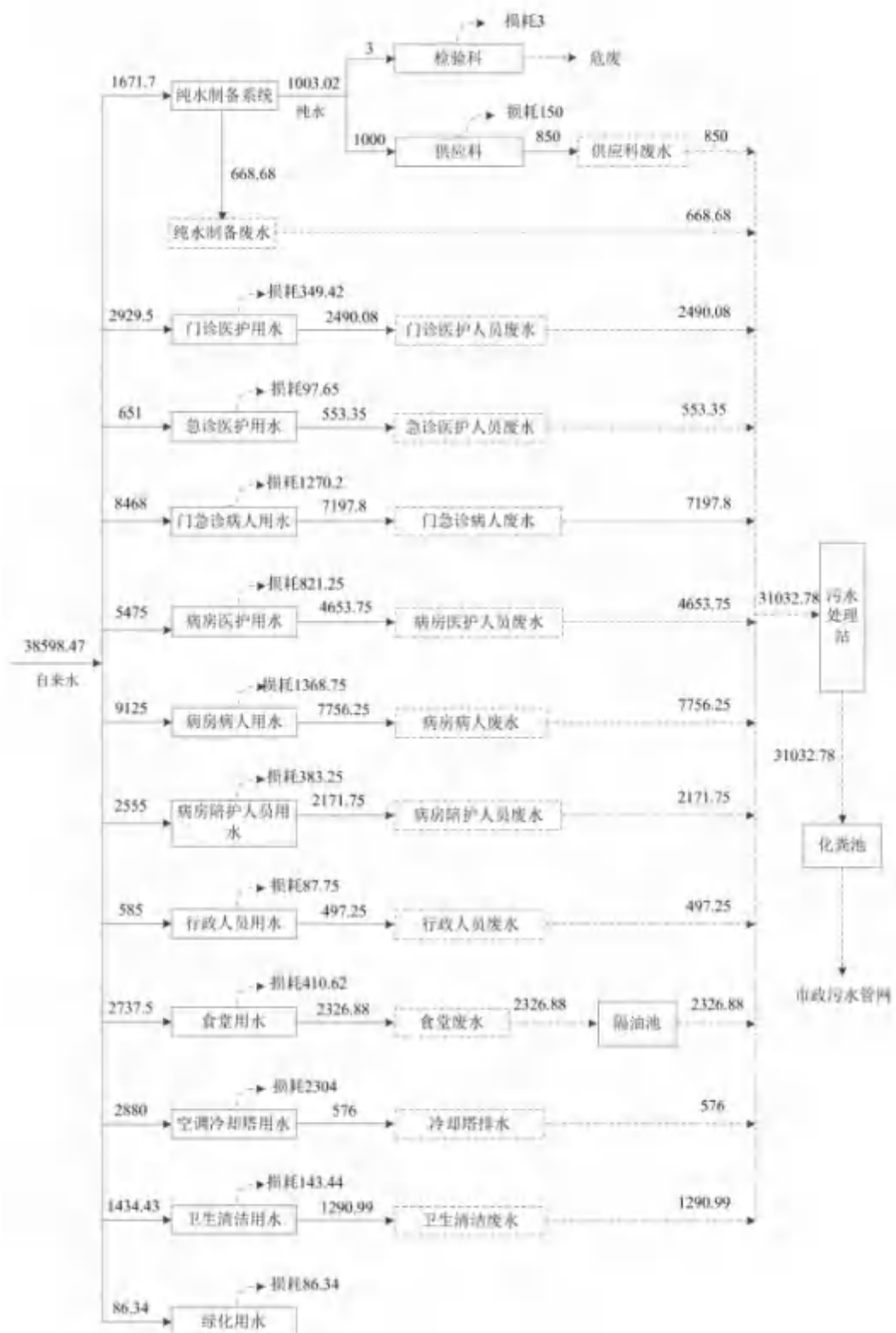
图 2-2 项目年水平衡图 (单位: \text{m}^3/\text{a} )
